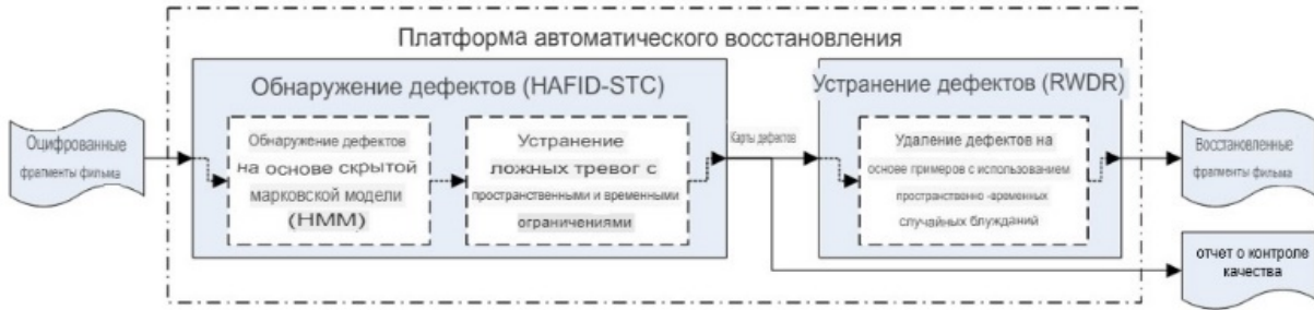
Рис. 1. Обобщённая схема автоматической реставрации: обнаружение дефектов и восстановление повреждённых областей
