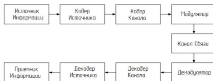
Рис. 4. Простейшая схема функционирования гидроакустического канала связи
