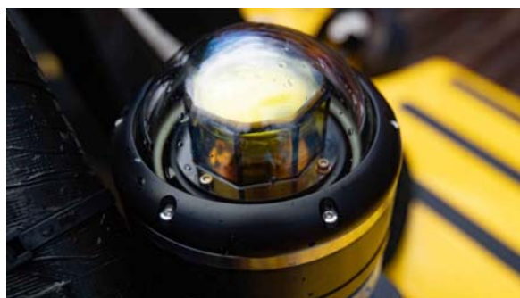
Рис. 3. Оптический подводный модем BlueComm
