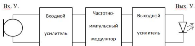
Рис. 2. Упрощенная структурная схема оптического передатчика
