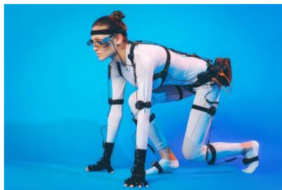
Рис. 3. Пример механической системы захвата движений
