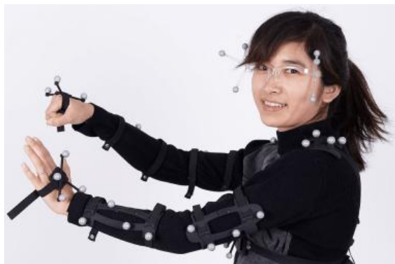
Рис. 4. Пример гибридной системы захвата движений
