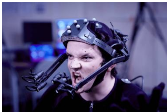
Рис. 5. Пример системы захвата движений с датчиком глубины
