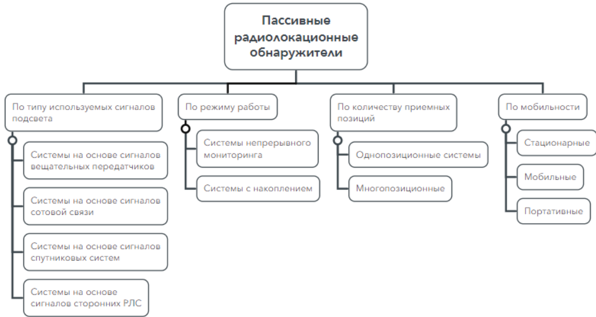
Рис. 2. Классификация пассивных радиолокационных обнаружителей
