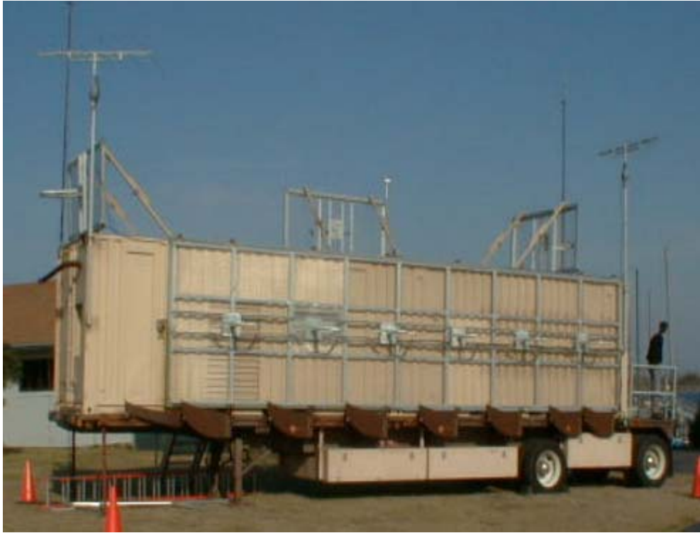
Рис. 3. Система «Silent Sentry» на передвижном контейнере с обрабатывающей аппаратурой
