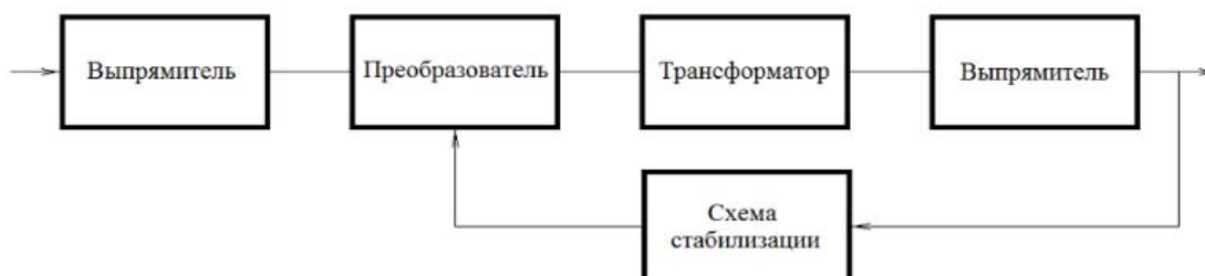
Рис. 2. Структурная схема импульсного блока питания (ИБП)
