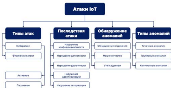
Рис. 3. Графическое представление угроз безопасности Интернета вещей, включая различные типы атак, последствия атаки, обнаружение аномалий и типы аномалий
