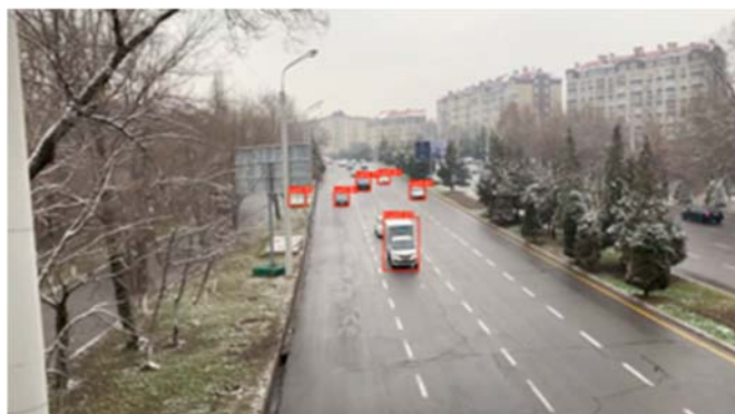
Рис. 3. Кадр из видео, снятого для тестирования, на котором видно не определенвшийся объект, частично скрывающийся за другим
