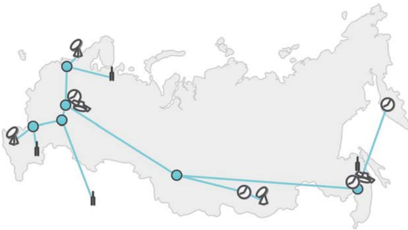
Рис. 5. Опорная сеть ЧВО на сети РТК и ее потребители: ГЭВЧ, РСДБ телескопы, космодромы, центральные синхронизаторы ГЛОНАСС
