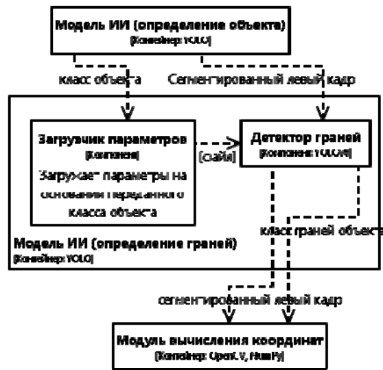
Рис. 7. Схема модели ИИ для детектирования граней объекта (Диаграмма компонентов)
